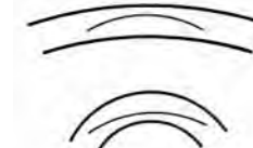
Abb. 18 Krümmungskontrast nach Höfler Derselbe Kreisbogen erscheint zwischen den flacheren Bögen stärker, zwischen den steileren Bögen schwächer gekrümmt.
